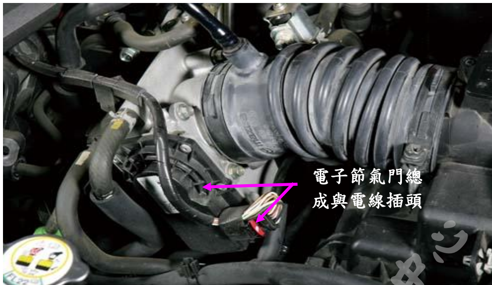
圖 8 電子節氣門總成與電線插頭
