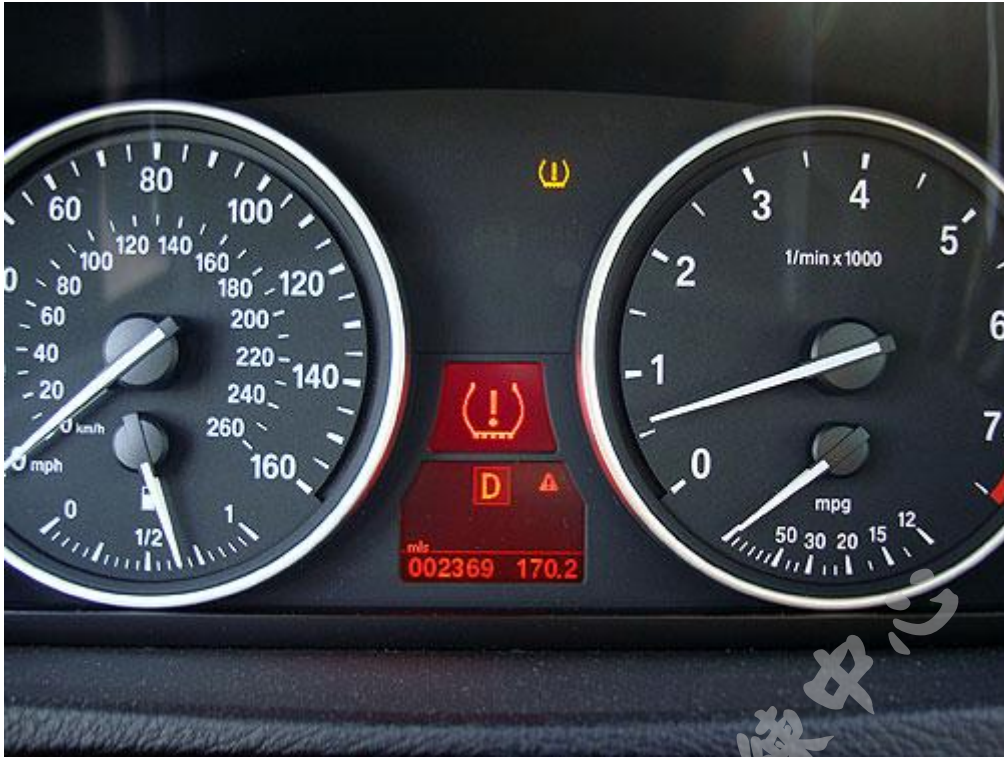
圖五 胎壓監測系統警告指示燈
