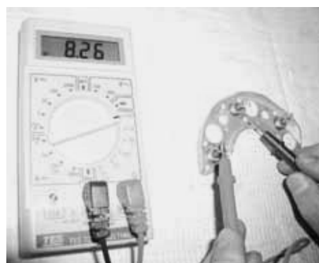
圖15 檢測正極整流子是否正常〔3〕
