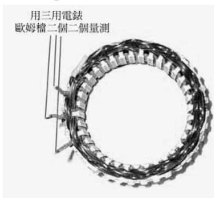
圖9 檢查靜子線圈是否有斷路狀況
