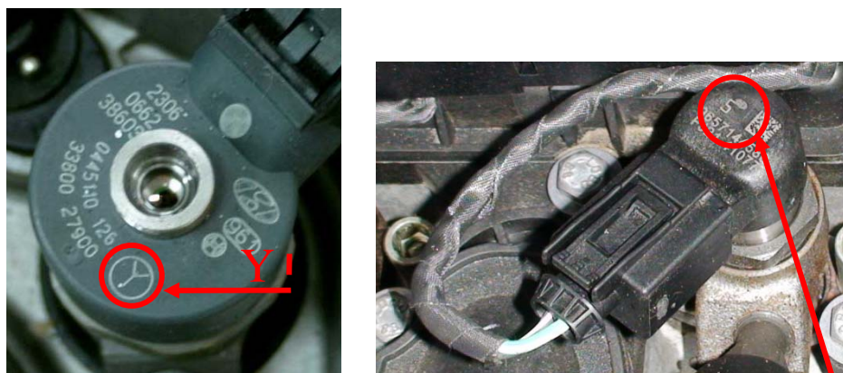
圖 4 噴油器的安裝編號或記號
