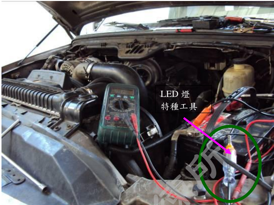
圖二 使用裝設有LED燈特種工具診斷FORD電腦控制柴油車的故障
