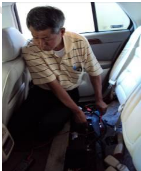
圖五 使用三用電錶，檢測 GM Cadillac 高級轎車電瓶的漏電量
