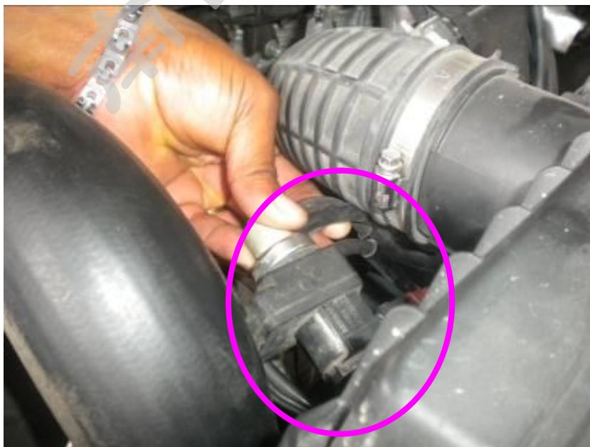
圖十二 VGT 排氣渦輪增壓器真空膜片器的真空管電磁閥與電線插頭
