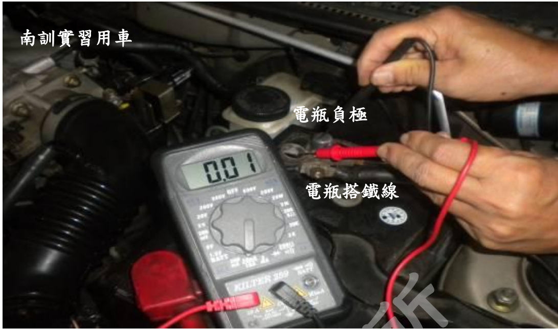
圖六 使用三用電錶的 10A 電流插孔串聯於電瓶負極與搭鐵線間 檢測全車系電器開關皆 OFF 時的實車電瓶漏電量為 0.01A。
