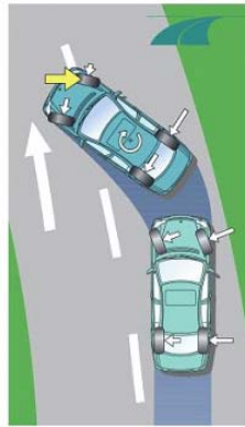
圖 2 VDC 系統於轉向過度時之作用情形
