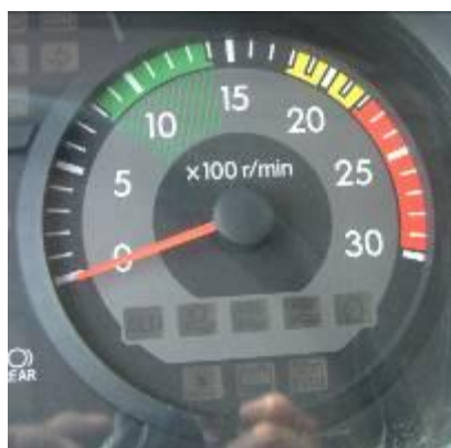
圖 3 大型柴油車的引擎轉速錶
