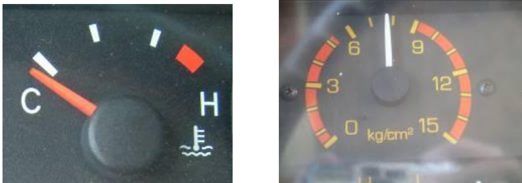
圖 2 大型車輛水溫錶與氣壓錶
